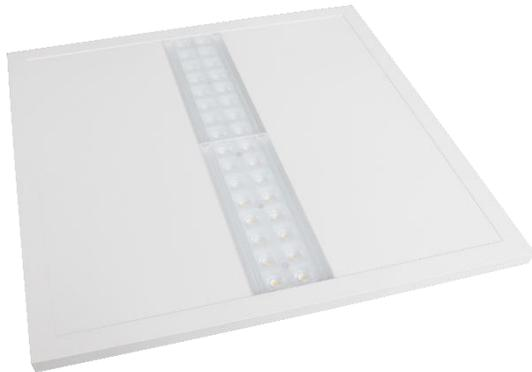
LED-Einlegepanel mit innovativer Gem-Cluster-Technologie für erstklassige 150 lm/w Systemeffizienz, sowie UGR <19, im modernes und stilvolles Design. CRI90, 622x622x25mm
